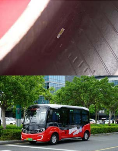
ชิปอัจฉริยะในยางรถโดยสารประจำทางไร้คนขับ ที่ใช้เทคโนโลยี 5G ที่เขตหุหลี่
